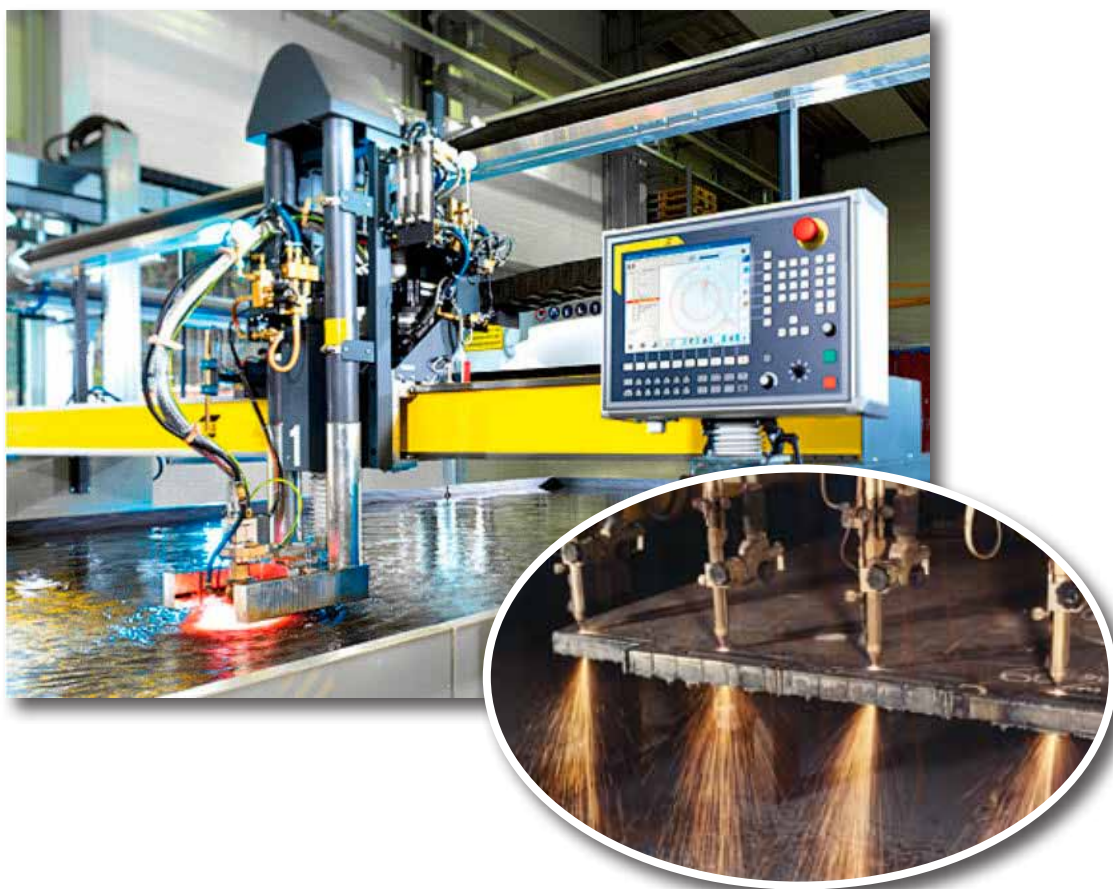
Detalj rezanja na pantografu
