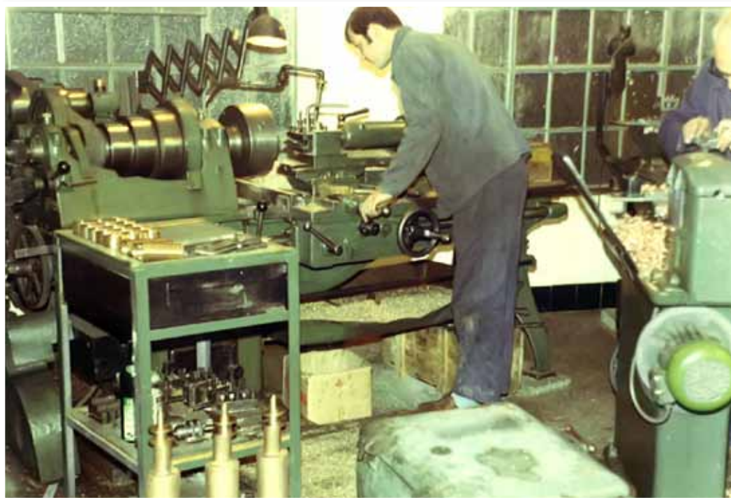
Josip Brezac obrađuje brodske ventile
